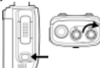
Rote la perilla del selector de canal para elegir el canal deseado. Presione el botón del monitor para chequear la actividad del canal. Para evitar interrumpir otro usuario, asegúrese de que el canal está limpio antes de usted comenzar a transmitir.
